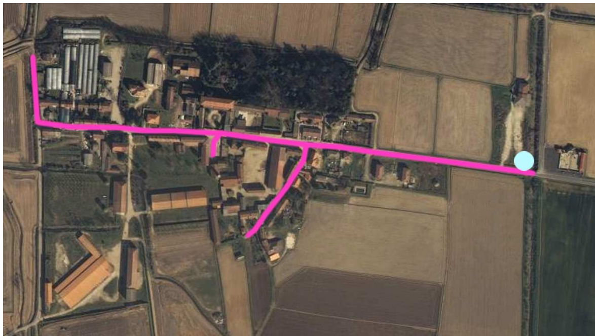
Figura 66: Sistema fognario e fossa imhoff
